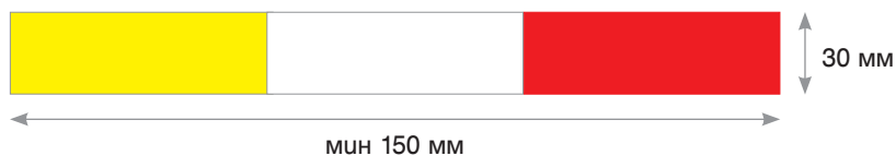
Фиг. 6. Лентова маркировка за поставяне върху естествена основа
