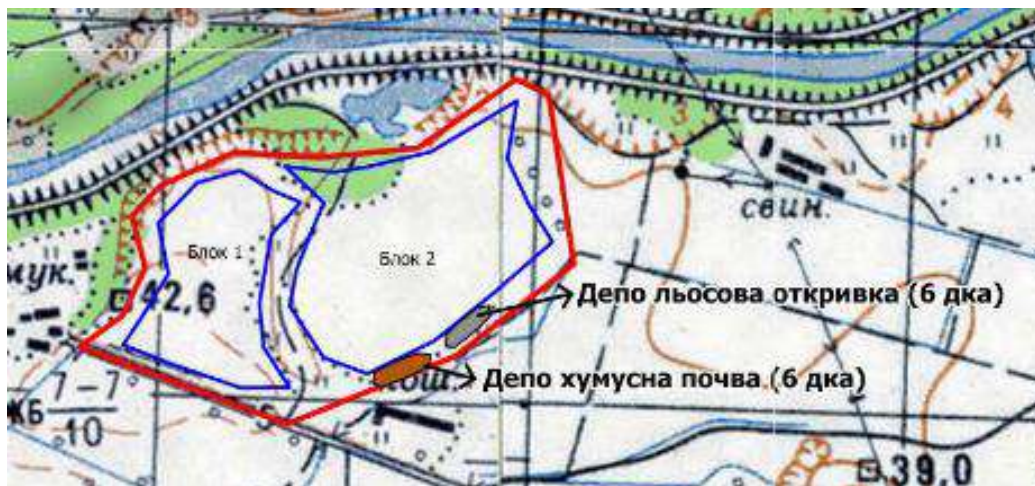
Фигура 2.2-4 – Местоположение на контура (червен) на находището, контура на запасите (син цвят) и контурите на площадките по чл. 16, ал. 4, т. 1 от наредбата (депата за хумусна почва и лъсочидна глина до лъсочидна глина).
