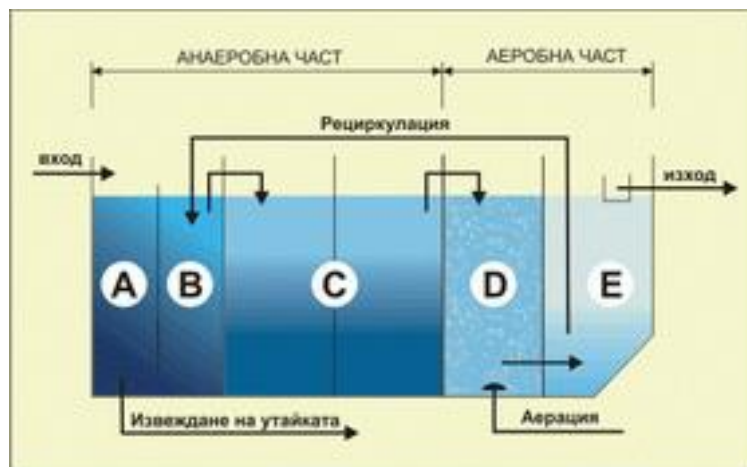
Фигура 3. Принципна схема на пречистване на отпадъчни води
