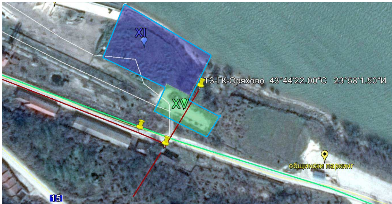
Фиг.1.6.-2 Водопровод (зелен цвят) и канал (кафяв цвят) до и през имота, предмет на инвестиционно планиране (син цвят –УПИ XI, обединен от XI и XV)
